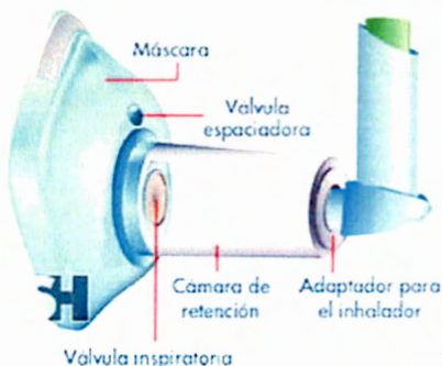
Fig 2. Dispositivo pMDI acoplado a cámara.
